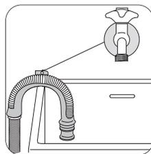
**Подвесить над краем раковины, используя пластмассовую направляющую, входящую в комплект поставки**
