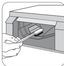
Po vyjmutí zásuvky použijte malý kartáček na čištění prostoru na zásuvku tak, abyste z vrchních i spodních částí prostoru odstranili všechny usazeniny pracího prášku.
