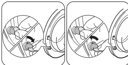
**Toto zařízení se** aktivuje pootočením tlačítka (bez stisknutí) uvnitř dvířek doprava, až je zářez vodorovně. Podle potřeby použijte i minci.
